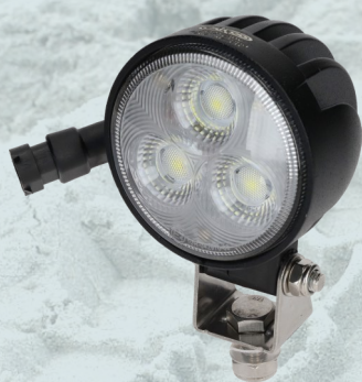
172321 - LED Arbejdslygte 10-30V - 45W - 4000 lumen 85x76mm- IP 69K - Flood CISPR 25 Class 4 - AMP stik
