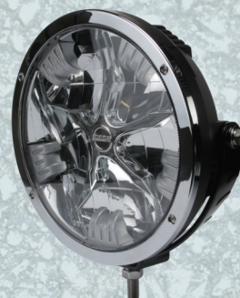
172060 - LED Fjernlygte 9-36V - 50W - 4500 lumen 246.5x237x95.9mm - IP 69K ECE R7, R112 Med positionslys
