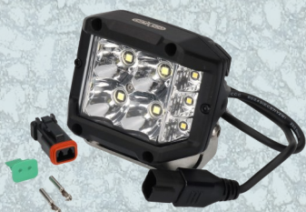
172259 - LED Fjernlygte 10-30V - 29W - 2098 lumen 97x78x73mm - IP 69K DT multistik - ECE R7, R112 Med arbejdslys
