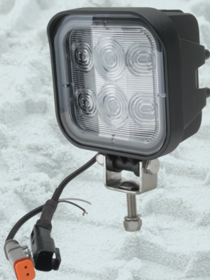
172129 - LED Arbejdslygte 12-36V - 40W - 4800 lumen 136.1x110x65.9mm - IP 69K Flood - DT multistik - ECE R10
