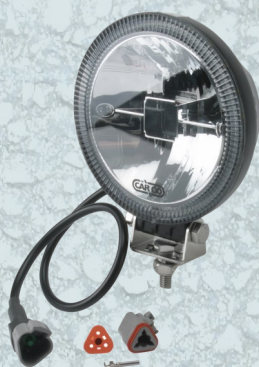
172212 - LED Fjernlygte 10-30V - 20W - 1800 lumen 127x89x61mm - IP 67/69K DT multistik - ECE R7, R112 5" - Med positionslys
