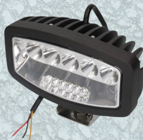
172237 - LED Fjernlygte 10-60V - 25W - 2000 lumen 179x135x88mm - IP 68 ECE R7, R112 Med positionslys
