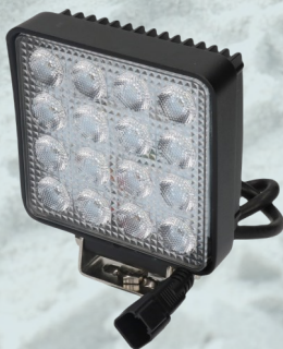
172232 - LED Arbejdslygte 10-80V - 45W - 3360 lumen 109x109x48.5mm - IP 67 Flood - DT multistik - ECE R10
