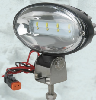
172191 - LED Arbejdslygte 10-30V - 40W - 3200 lumen 170x82x80mm - IP 69K - Flood DT multistik - ECE R10
