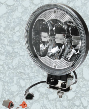
172059 - LED Fjernlygte 10-30V - 60W - 5400 lumen 222x177.8x79mm - IP 67 DT multistik - ECE R7, R112 7" - Med positionslys
