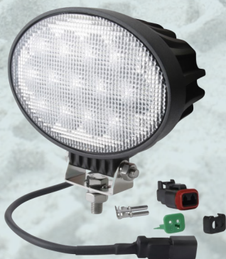
172045 - LED Arbejdslygte 10-80V - 65W - 5850 lumen 165x142x94.5mm - IP 69k Flood - DT multistik - ECE R10
