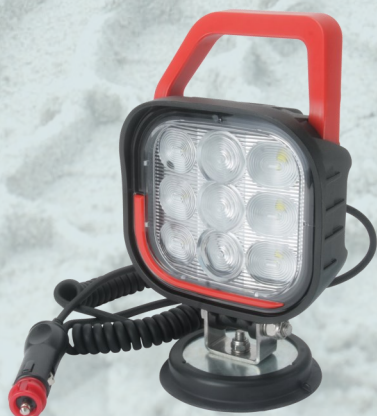
172130 - LED Arbejdslygte 12-36V - 22W - 2160 lumen 202.2x125x92.7mm - IP 69k Flood - DT multistik - ECE R10
