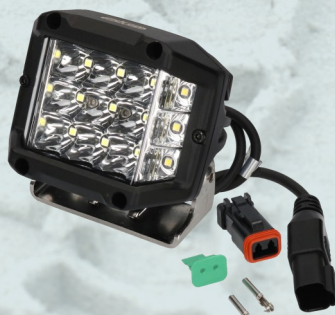
172260 - LED Arbejdslygte 10-30V - 22.5W - 2850 lumen 97x78x73mm - IP 69K - Combo DT multistik - ECE R10
