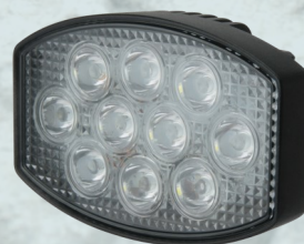
172143 - LED Arbejdslygte 10-30V - 15W - 1426 lumen 150x80x38mm - IP 67 - Flood DT multistik - ECE R10
