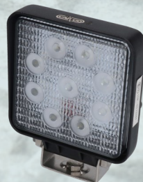
172262 - LED Arbejdslygte 10-30V - 27W - 2100 lumen 110x110x42mm - IP 67 - Flood ECE R10 - Uden stik
